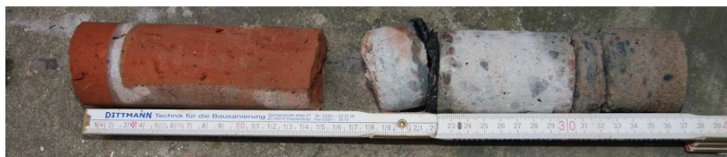
Rys. 8. Rdzeń wycięty z konstrukcji stropu
